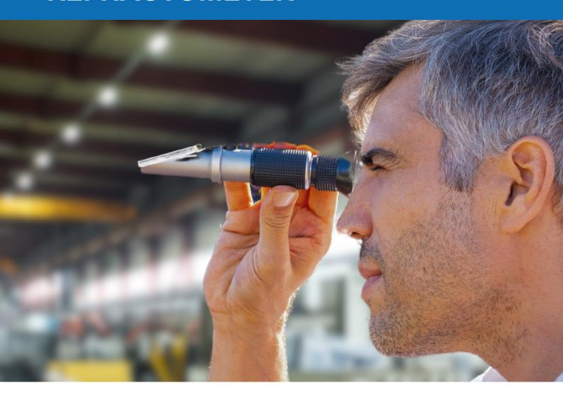
OPERATION MANUAL FOR HAND HELD BRIX REFRACTOMETER
